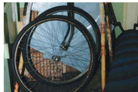
С помощью велосипедных колес делались одометры для измерения пройденного расстояния
