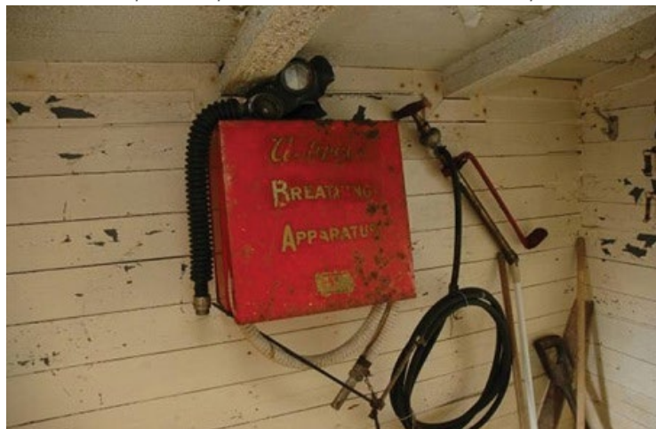
Дыхательный аппарат и подвесной насос, висящие на стене входной части хижины
